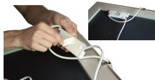
4. Irrota LED valaisimen virtalähteen takana olevien kiinnitystarrojen suoja ja liimaa virtalähde peilin taakse kuvan osoittamaan paikkaan.
