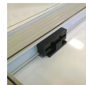
4. Kun koukkuosat ovat kiinnitetty seinään, peili ripustetaan koukkuihin kehyksosastaan. Kehyksosat liikkuvat urassaan, mikä helpottaa sivusuunnan aseointia.
